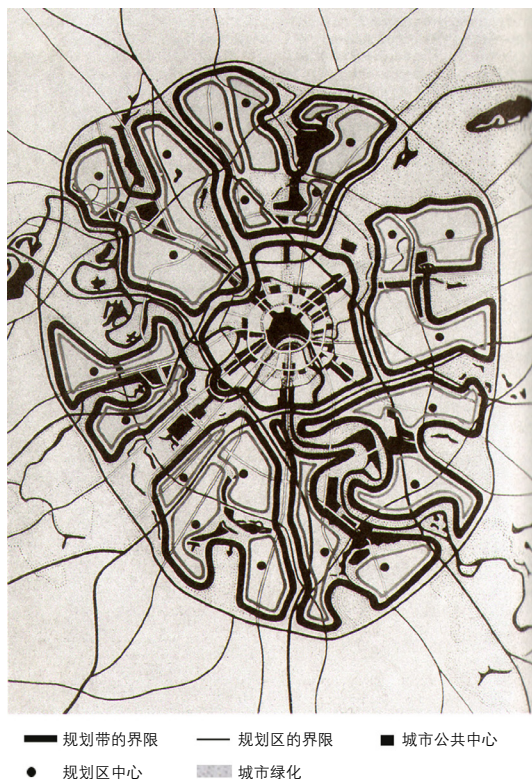
图 1 1971 年莫斯科市城市总体规划——整个城市被划分成八个人口和工作地点均等的规划区 资料来源：1971 年莫斯科市总体发展规划战略，米哈伊尔·波索欣
